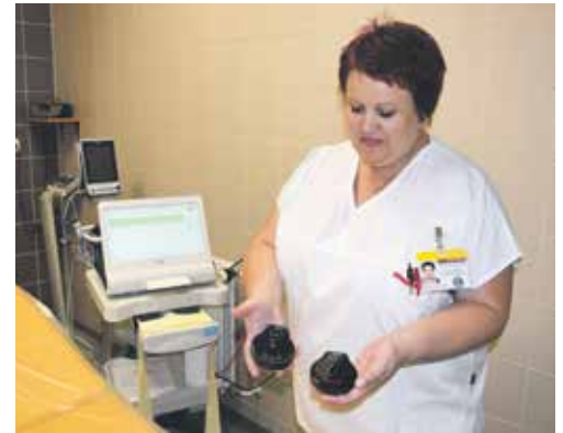
KARDIOTOKOGRAF s telemetrickou jednotkou a centrální monitorovací stanicí registruje děložní kontrakce, srdeční činnost a pohyby plodu, aniž by rodička musela být připojena k danému přístroji.
